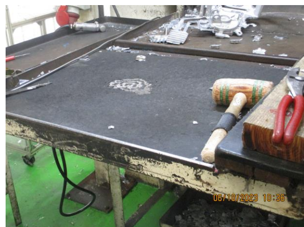
รูปที่ 6 การใช้แผ่นยาง/แผ่นไม้รองรับในกระบวนการเคาะชิ้นงาน
