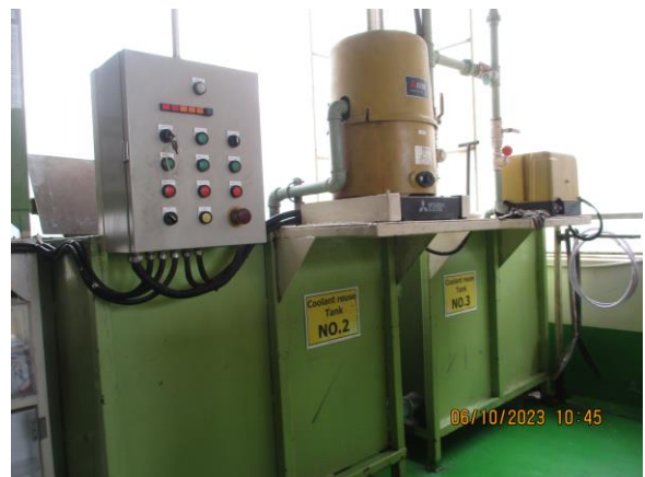
รูปที่ 3 กระบวนการแยกน้ำมันปนเปื้อนออกจากวัตถุดิบ
